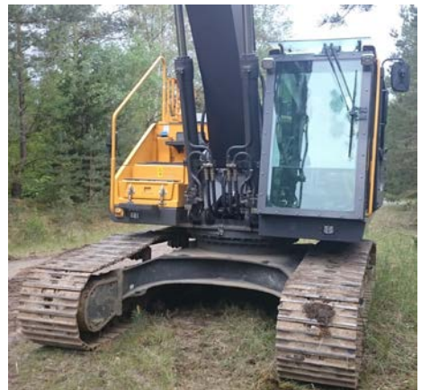
Abb. 34 Bagger mit Sicherheitssonderverglasung
