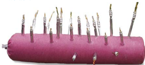
Abb. 35 Vernichtung von Zündern durch Sprengstoff
