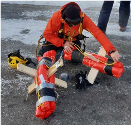
Abb. 46 Herstellen einer Wurfladung
