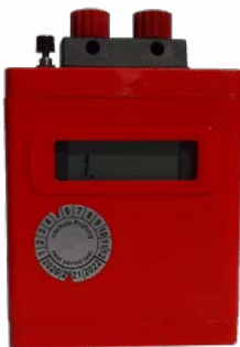
Abb. 18 Beispiel für einen Zündkreisprüfer, der auch zur Nebenschlussmessung geeignet ist
