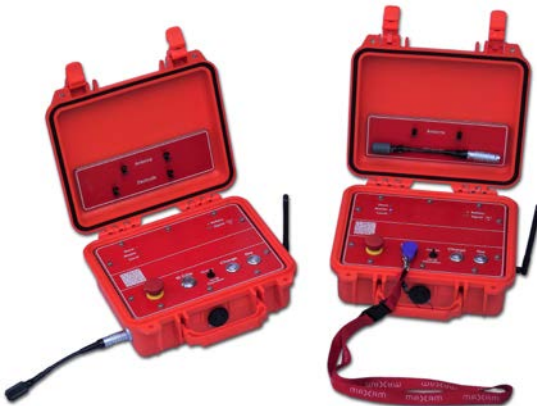
Abb. 22 Beispiel eines Zündgerätes für nicht-elektrische Zündanlagen
